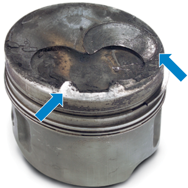
Abb. 4 Anschlagspuren durch motorische Überhitzung
